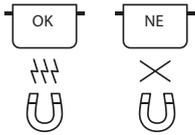
Používejte pouze hrnce a pánve vyrobené z feromagnetického materiálu, které jsou vhodné pro používání na indukčních varných deskách:
